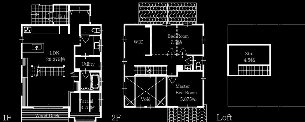
LDKの中心に階段を設置すると視線を遮ってしまいますが、今回はスチール製のオープンスリット階段を設けたことでリビングとキッチンの繋がりを出しました。吹き抜けからの日差しが、階段越しからキッチンへ届きます。
